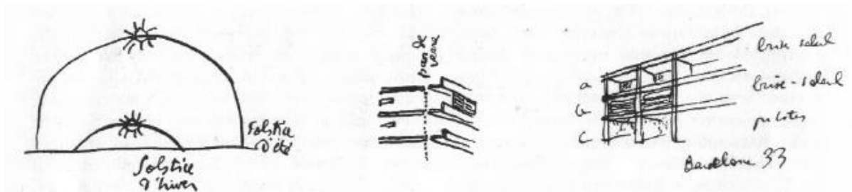
Figura 21: Croquis de Le Corbusier com estudos sobre proteções solares e a solução para o prédio de apartamentos em Barcelona (Fonte: OLGAY; OLGAY, 1957, p.10)
