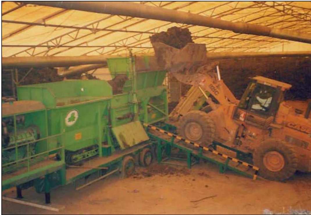
Figura 22 – Máquina para homogeneização do solo contaminado (“toupeira”) utilizada na estação de biorremediação das empresas SAPOTEC LTDA. e ESTRE LTDA., Paulínia – SP.
