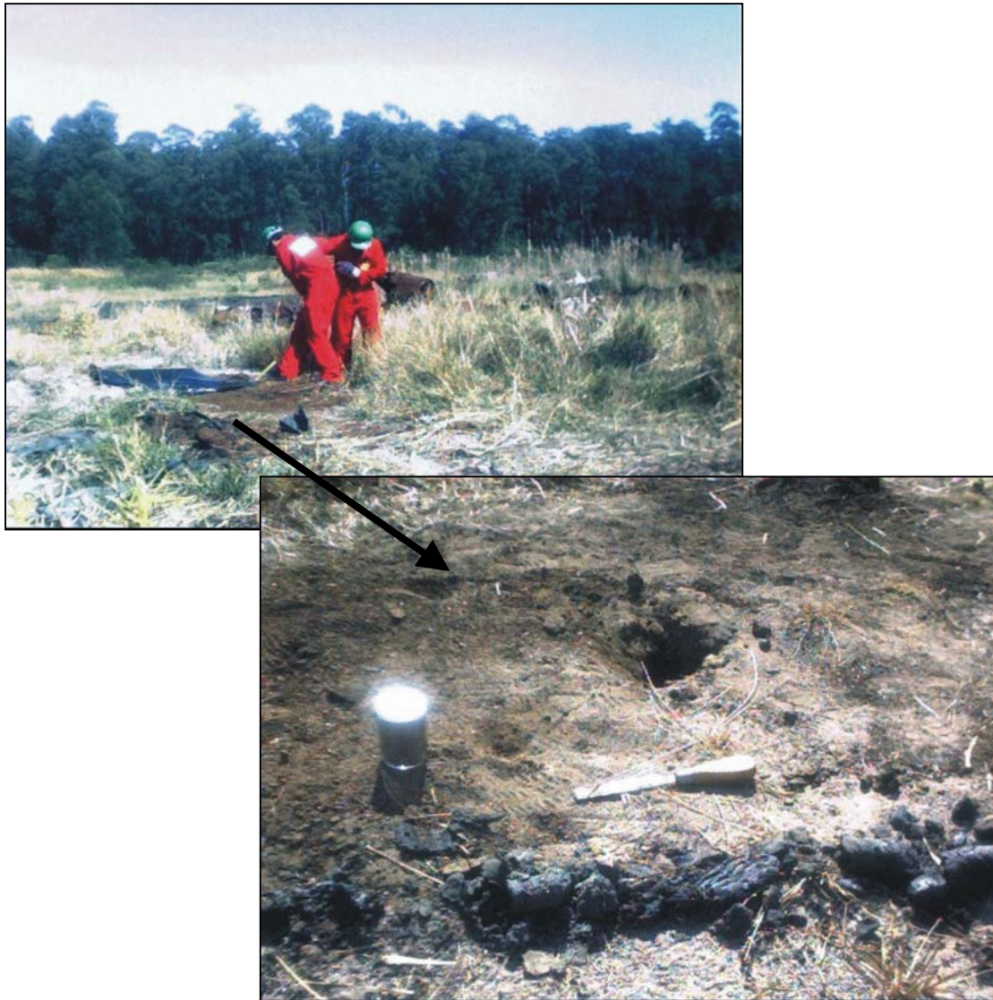
Figura 16 – Amostragem de solo para caracterização química, na Mina de Argila/REPLAN, Paulínia – SP. Detalhe dos pontos de sondagens, agosto de 2002.
