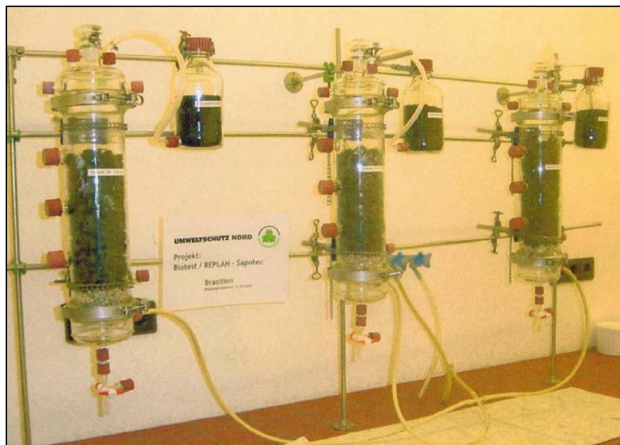
Figura 17 – Ensaio de coluna realizado nas amostras de solo contaminado da Mina de Argila/REPLAN, Paulínia – SP, laboratório da UMWELTSCHUTZ NORD GMBH, Alemanha, setembro de 2002.
