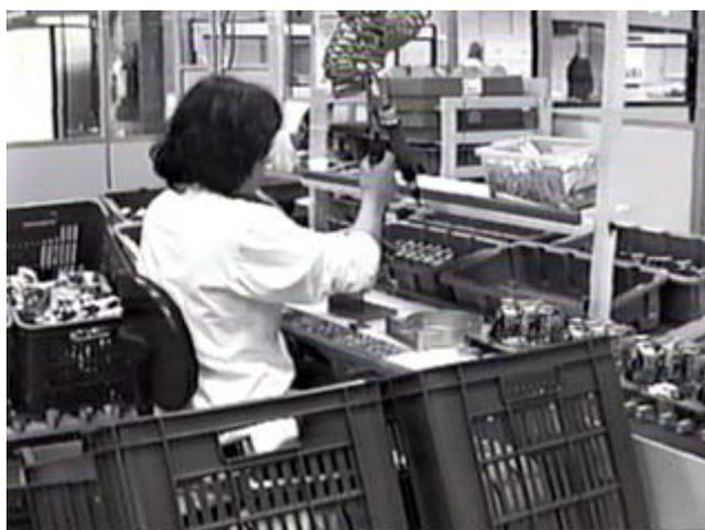
Figura 17: Posto integrado 1 da célula de montagem inicial polifásica. Note a quantidade de componentes sobre a bancada e no entorno do posto.
