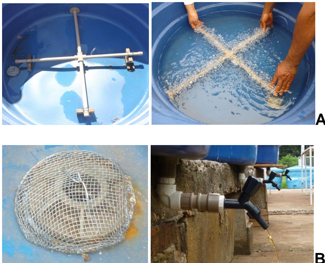
Figura 4. Sistema utilizado para o insuflamento de ar nas caixas e calibração do sistema (A) e dreno no fundo da caixa e torneira para a coleta de lixiviados e chorume (B).
