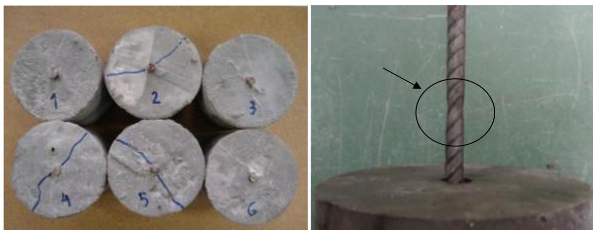
Figura 5.10 – Fotos (a) corpos de prova (T2 - 28 dias) após o ensaio tipo push-in, onde foi observado fendilhamento (50%) e deslizamento (50%) (b) Estrição do aço no ensaio tipo pull-out com deslizamento posterior (T3-28d).
