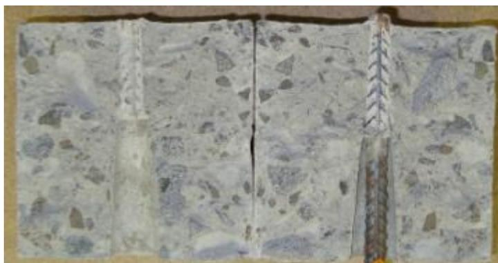
Figura 7.3 - Corpo de prova com composição mista de agregados graúdos (Campo).
