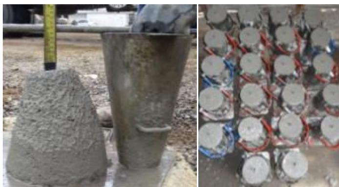
Figura 6.15 - (a) Foto mostrando o ensaio de abatimento de tronco de cone e (b) Foto mostrando os corpos de prova moldados.
