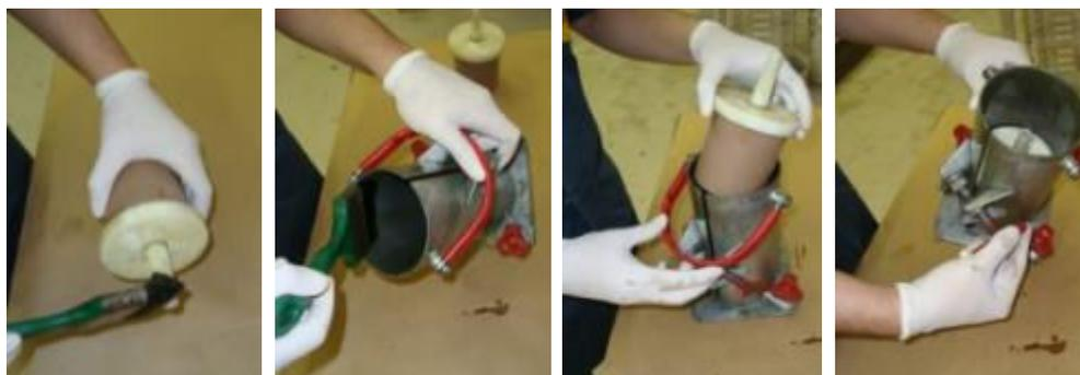
Figura 5.27 - (a) Aplicação de desmoldante no molde de fibra de náilon. (b) Aplicação de desmoldante (óleo mineral) no molde cilíndrico metálico ( $\text{Ø}100 \times 200 \text{mm}$ ); (c) e (d) posicionamento dos dois moldes.
