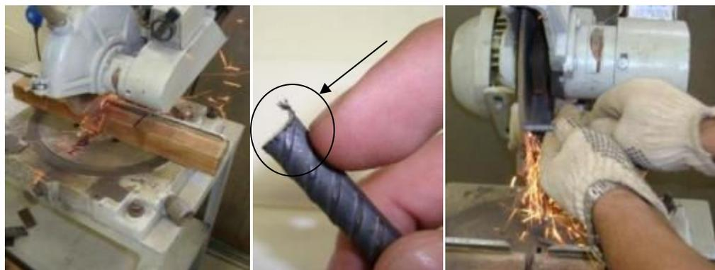
Figura 5.31 - (a) Corte da barra de aço; (b) Detalhe da aresta após o corte; (c) Retirada das arestas da barra de aço.
