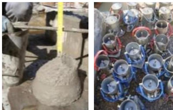
Figura 6.6 - (a) Foto mostrando o ensaio de abatimento de tronco de cone; (b) Foto mostrando os moldes preparados para moldagem e já moldados.
