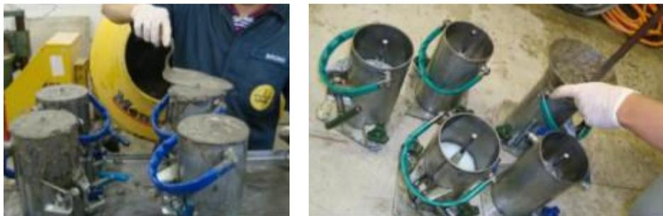
Figura 5.32 – Tipos de adensamento: (a) vibração mecânica em mesa vibratória e (b) vibração manual com haste metálica.
