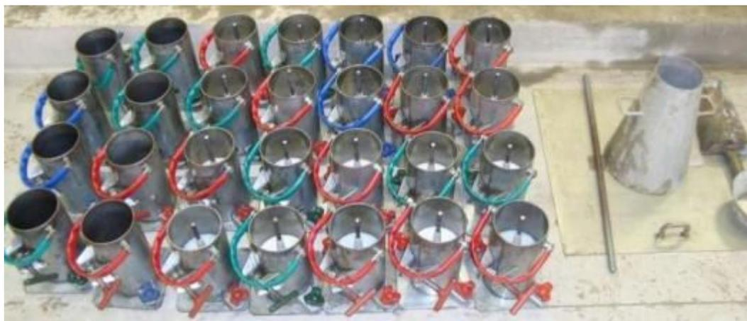
Figura 5.29 - Exemplo de arranjo final para uma concretagem com o método.
