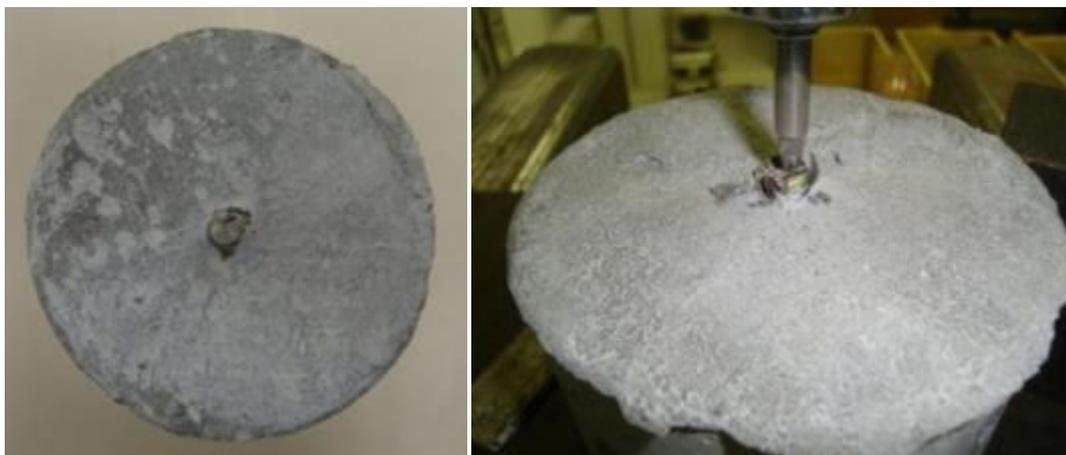
Figura 5.52- (a) Foto mostrando o tipo de ruptura por deslizamento da barra de aço. (b) Outro exemplo mostrando o tipo de ruptura por deslizamento da barra de aço no ensaio pull-out.
