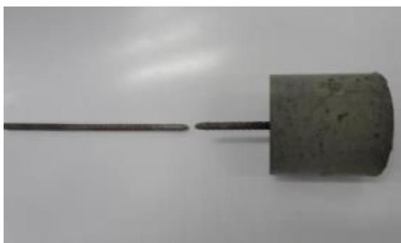
Figura 5.54 - Foto mostrando o tipo de ruptura por ruptura do aço por tração no ensaio tipo pull-out.
