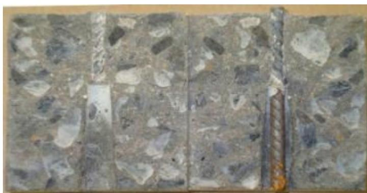
Figura 7.4 - Corpo de prova com apenas um tipo de agregado graúdo (Laboratório).
