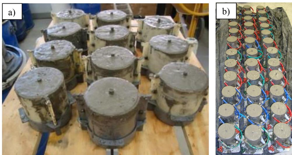
Figura 5.1 – (a) Foto mostrando os corpos de prova tipo pull-out e (b) Foto mostrando os corpos de prova tipo push-in, juntamente com os corpos de prova de controle da resistência à compressão ao fundo.
