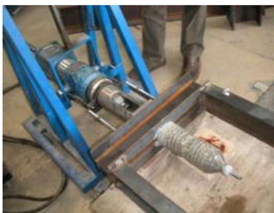
Figura 3.67 - Ensaio de arrancamento APULOT. (LORRAIN; BARBOSA, 2008)
