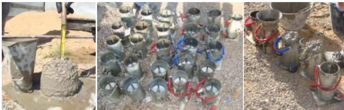
Figura 6.12 - (a) Foto mostrando ensaio de abatimento de tronco de cone; (b) e (c) Fotos mostrando os moldes preparados para moldagem e procedimento de moldagem.
