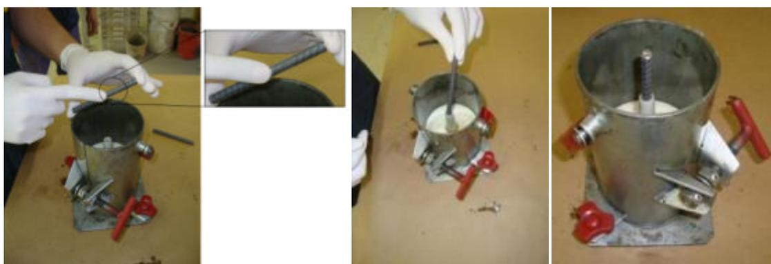
Figura 5.28 - (a) Posicionamento da barra de aço dentro da abertura circular no molde de fibra de náilon e detalhe da identificação da barra de aço; (b) e (c) Posicionamento da barra de aço e configuração final do arranjo dos dois moldes com a barra de aço no centro.
