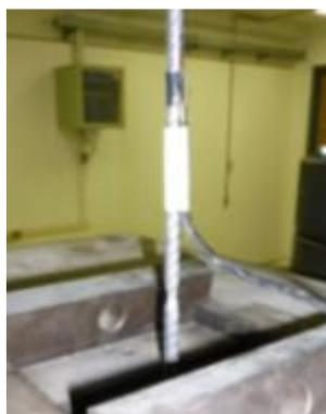
Figure 4.6 - Barra posicionada na prensa após a ruptura e localização do *strain gage*.
