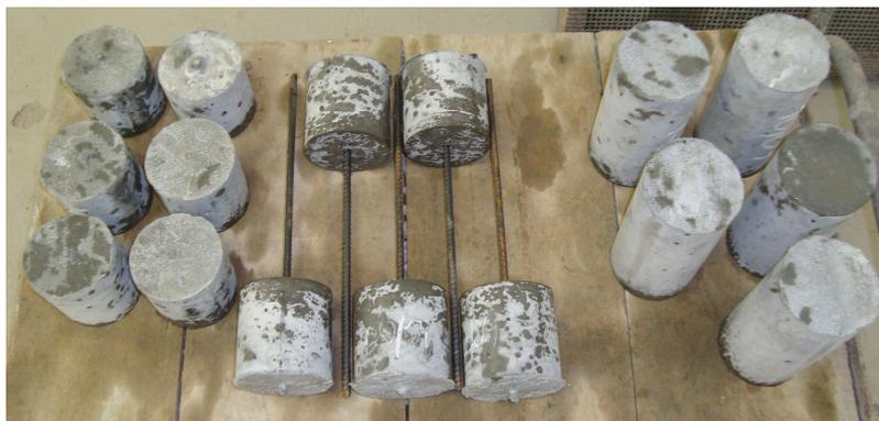
Figura 5.2 – Corpos de prova desmoldados: tipo push-in, tipo pull-out e para o controle da resistência à compressão (esquerda para direita na foto).
