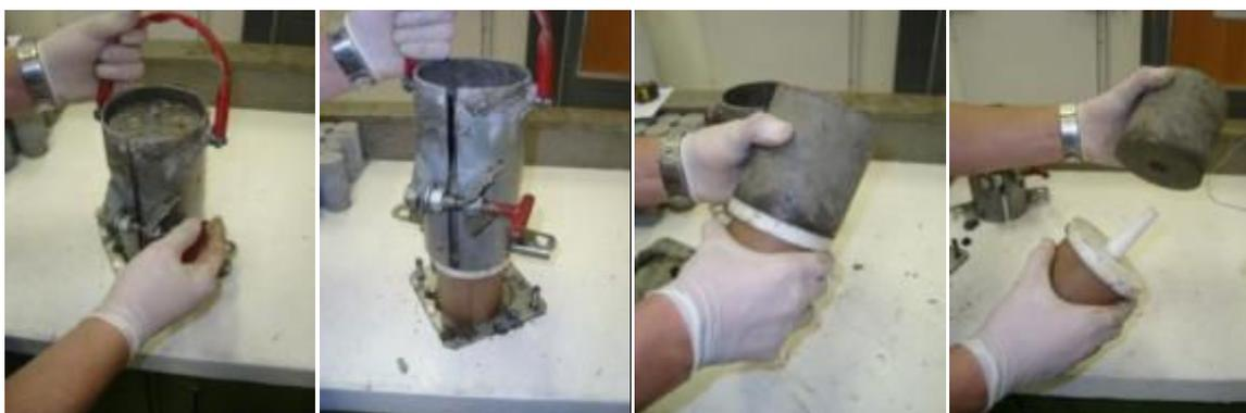
Figura 5.34 - (a) Retirada do molde metálico; (b) Separação dos 2 moldes; (c) Retirada do corpo de prova do molde de fibra de náilon; (d) Configuração final do procedimento de retirada do corpo de prova.
