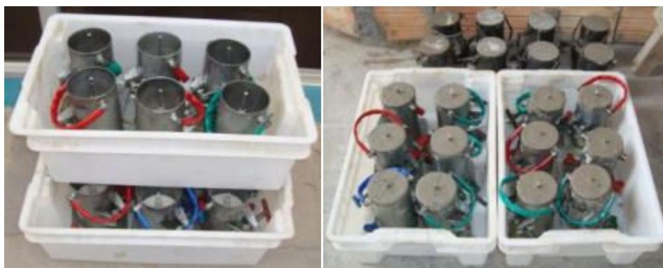
Figura 6.9 -(a) e (b) Foto mostrando os moldes preparados para moldagem e já moldados.
