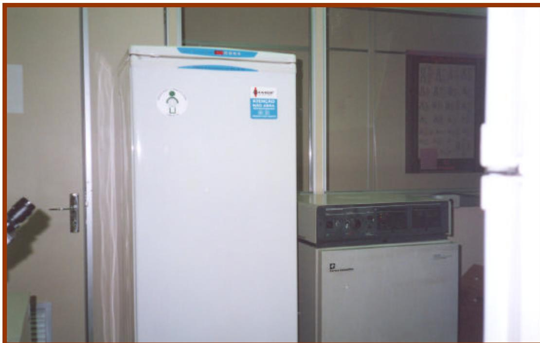
**Figura 3.** (C) Estufas com e sem injeção de CO<sub>2</sub>.
