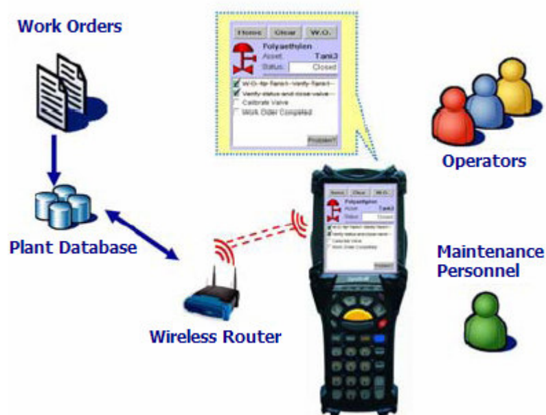
Figura 2.2 Exemplo de Comunicação de Dados com Pocket GENESIS [ICONICS, 2006]
