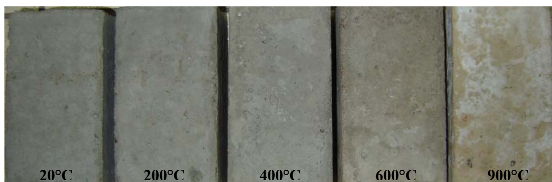
c) concreto confeccionado com basalto, resfriado bruscamente
