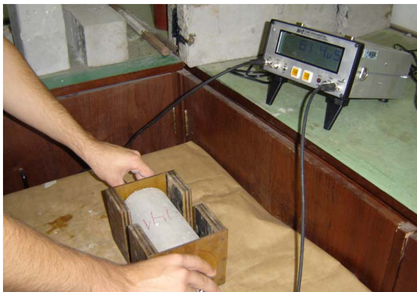
Figura 4.6: medição do tempo de propagação de ondas ultra-sônicas
