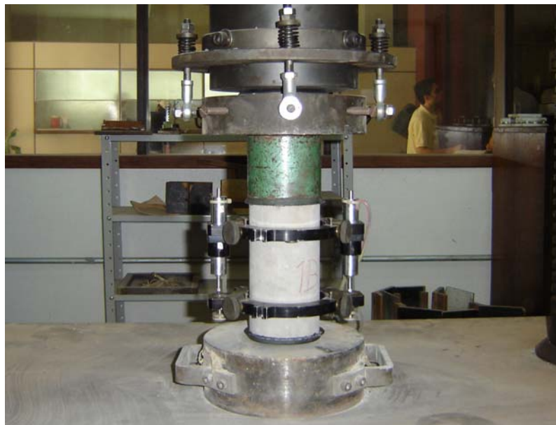
Figura 4.5: ensaio para determinação do módulo de elasticidade
