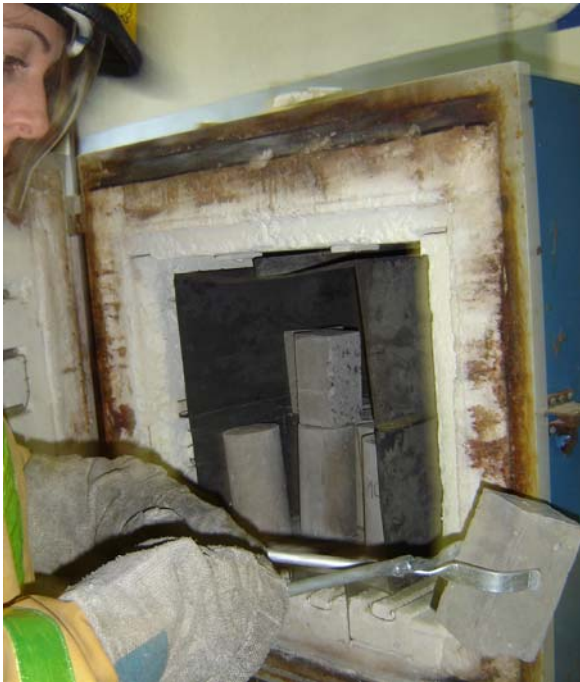
a) Retirada dos corpos-de-prova ainda quentes do interior do forno
