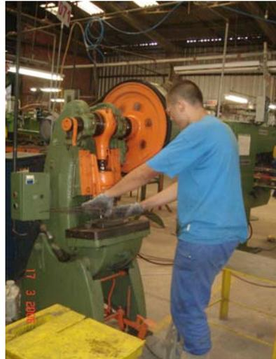
**Figura 13 - Eliminação de sobre medidas em prensa**
