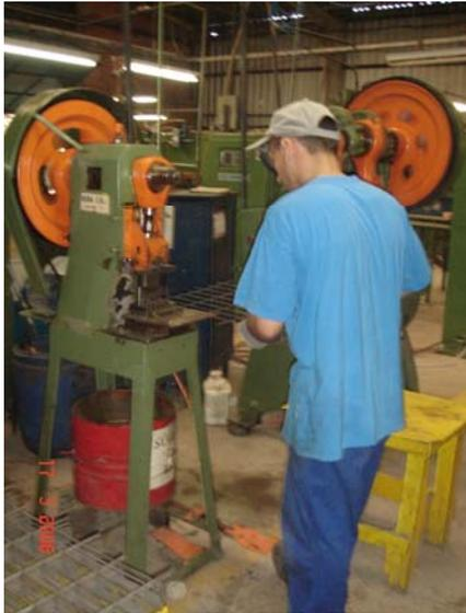
Figura 14 - Corte em prensa para medida final
