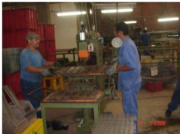
**Figura 11 - Solda-ponto, área de montagem das telas com as varetas e estocagem das telas já soldadas**
