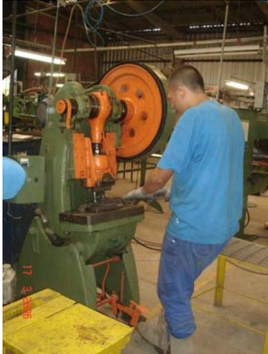
**Figura 12 - Eliminação de sobre medidas em prensa**
