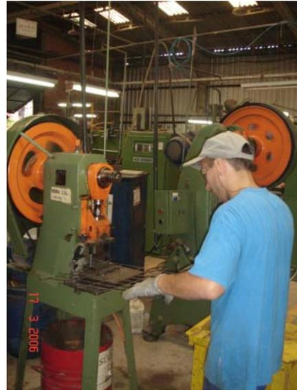
Figura 15 - Corte em prensa para medida final
