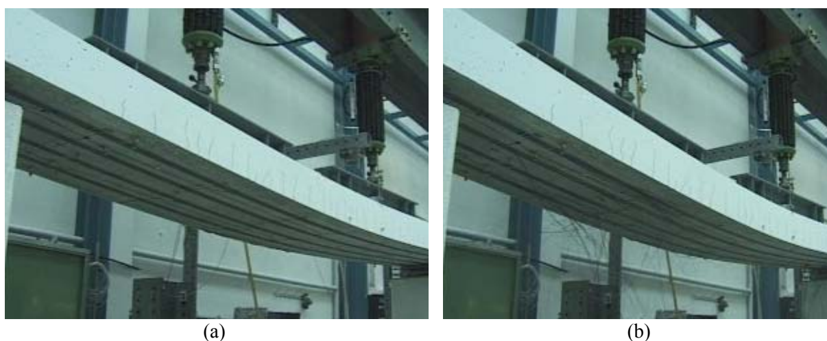
Figura 6.2 – Viga VFC_PE_02: (a) Durante o ensaio; (b) Após a ruptura do reforço por esgotamento da capacidade resistente do laminado de fibra de carbono.
