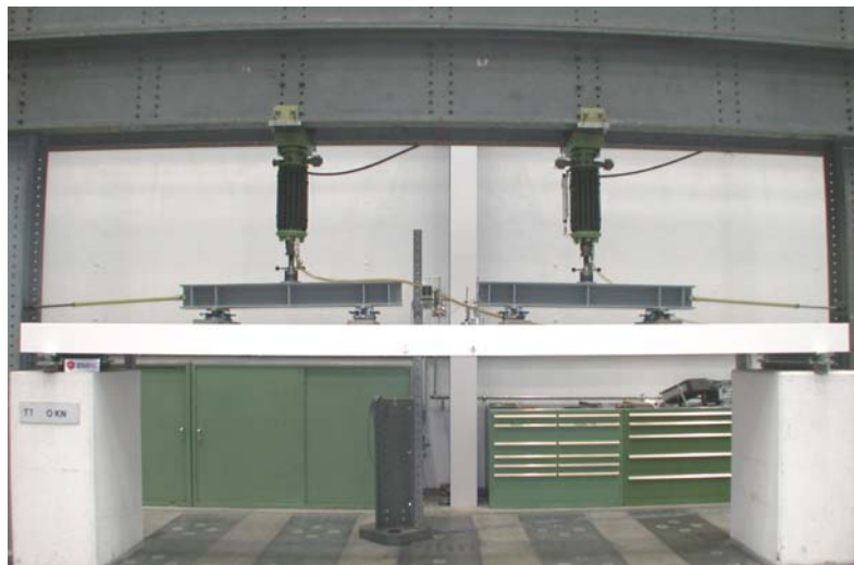
Figura 4.19 - Esquema de ensaio das vigas da segunda etapa da pesquisa.
