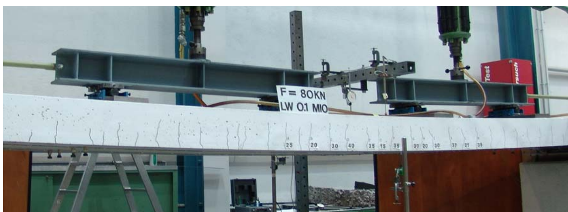
Figura 6.17 – Fissuras no centro do vão da viga VFC_PC_01 aos 100.000 ciclos.
