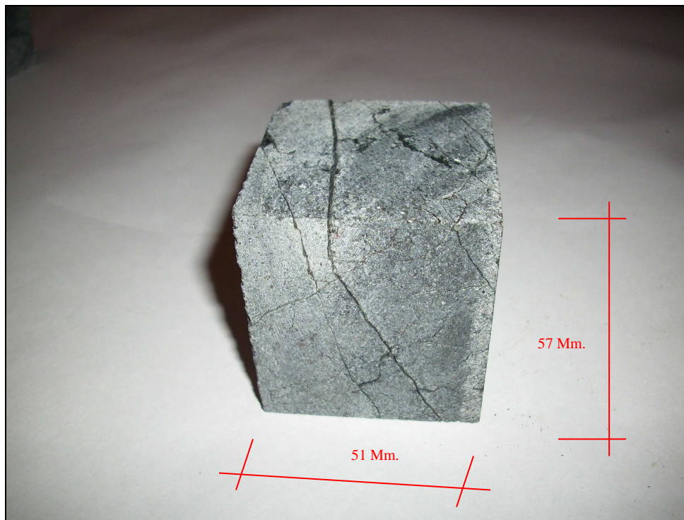
Figura 31 – Fisuración en el testigo.
