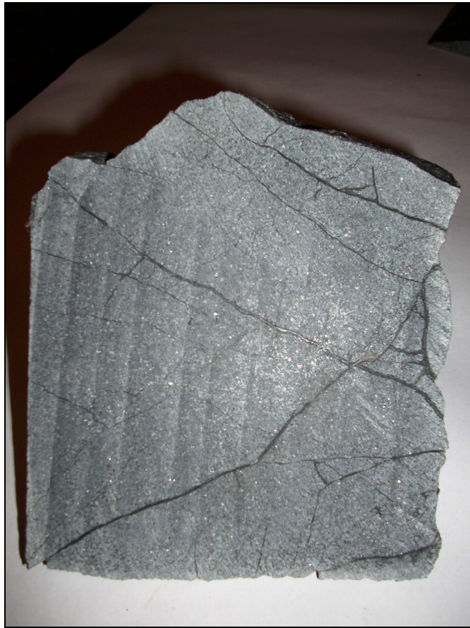
Figura 33 – Fisuración en la roca aserrada para la extracción de testigos. Cataclasis de la roca.
