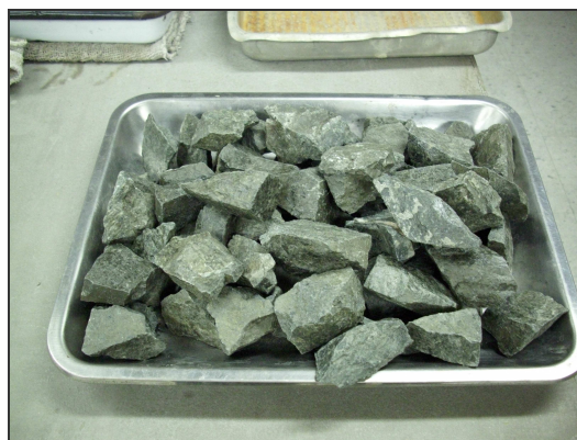
Figura 23 – Muestra para ensayo de densidad y absorción
