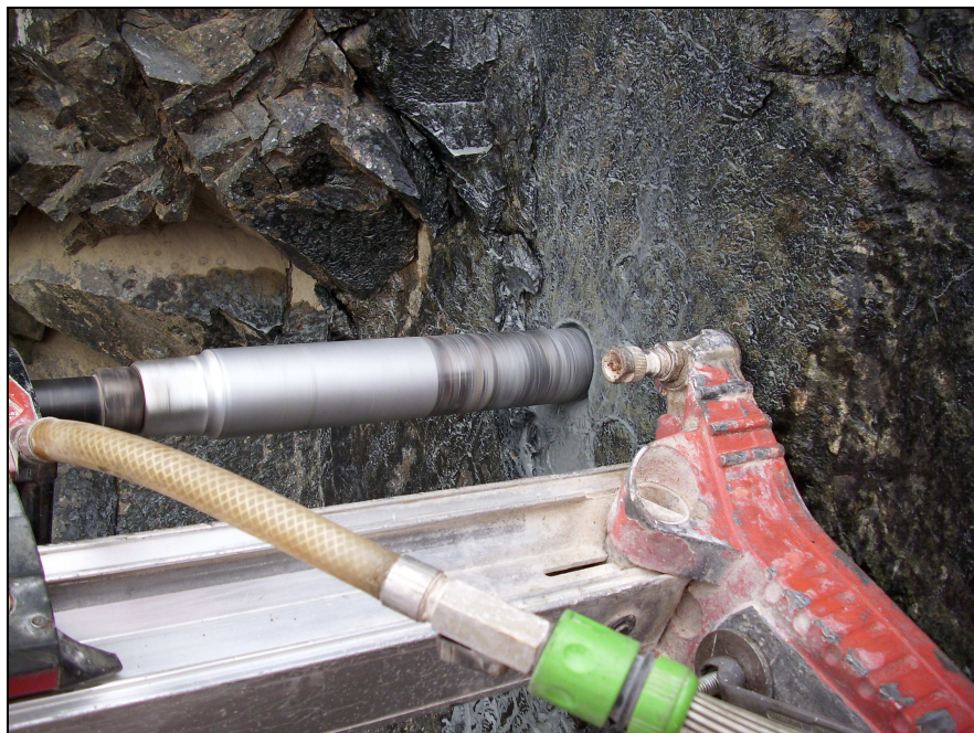
Figura 28 – Extrayendo el testigo directamente de la roca.
