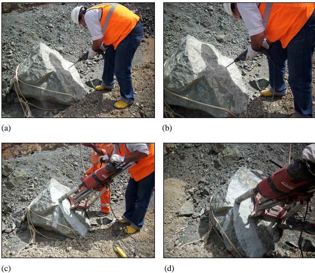
Figura 29 – Extracción de testigos de roca extraída a pie de la mina: (a) y (b) anclaje del equipo en la roca extraída; (b) y (c) perforando en la roca extraída.
