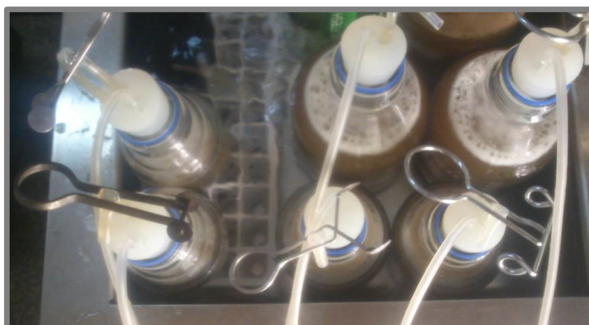
Figura 19 – Duplicatas das fermentações do mosto de cerveja para determinação de \text{CO}_2 .
