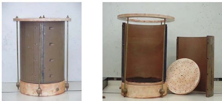
Figura 3.10: Foto da Célula desenvolvida para preparação de corpos de prova a partir da condição de lama.
