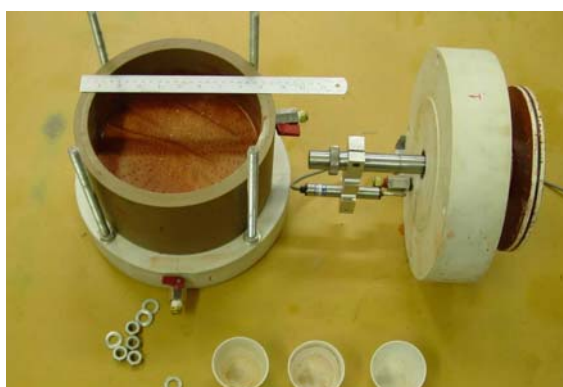
Figura 3.12: Foto da célula de adensamento de lamas desenvolvida
