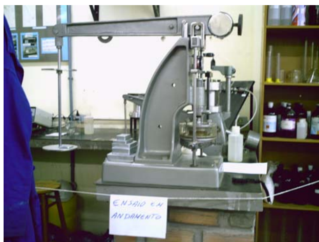
Figura 3.15: Equipamento de adensamento - UFRGS
