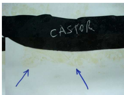
Figura 26. Processo de exsudação do óleo vegetal de mamona (Castor) já nas primeiras 48 horas após preparação da composição elastomérica, caracterizando a incompatibilidade com SBR.
