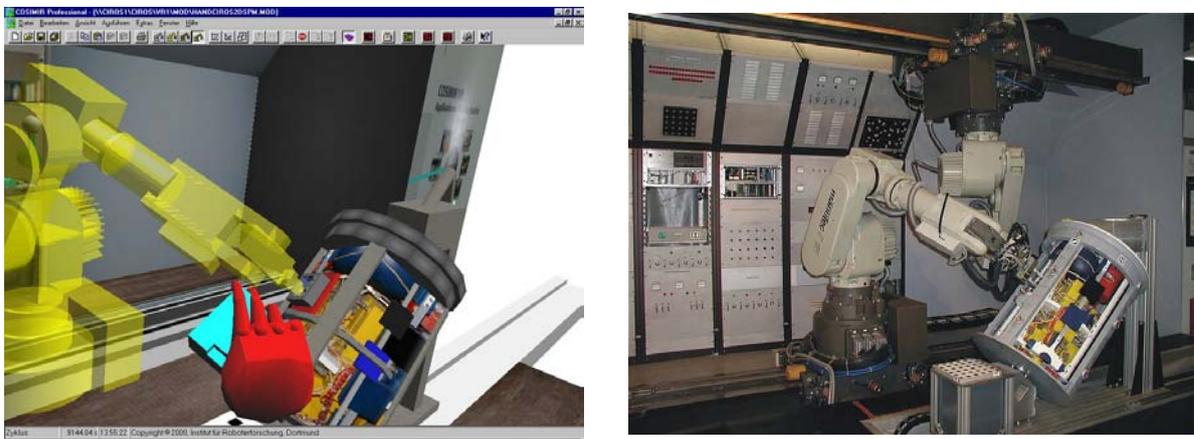
Figura 91. Simulação no COSIMIR vs. realidade.
