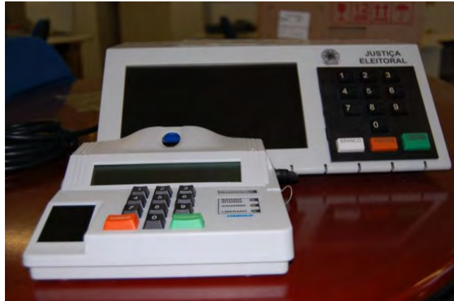
Figura 3 – Urna Eletrônica com identificador biométrico
