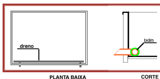
Figura 138: esquema da posição do tubo perfurado, em planta baixa e corte, respectivamente 22
