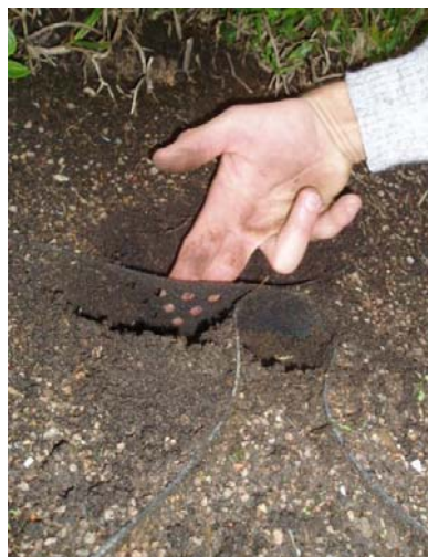
Figura 101: perfurações da geo-membrana (MENZ, 2004)
