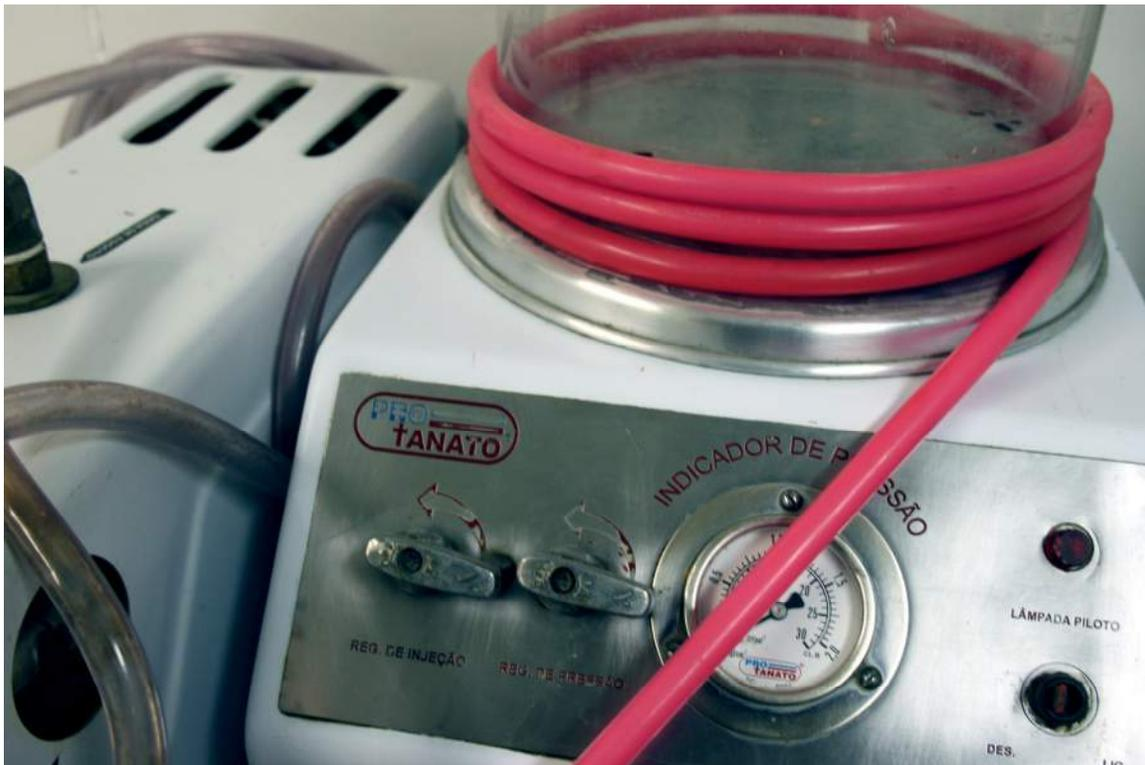
**Figura 12. Máquina de injeção e sucção de fluídos. Fotografia: Marcos Andrade Neves, 2013.**
