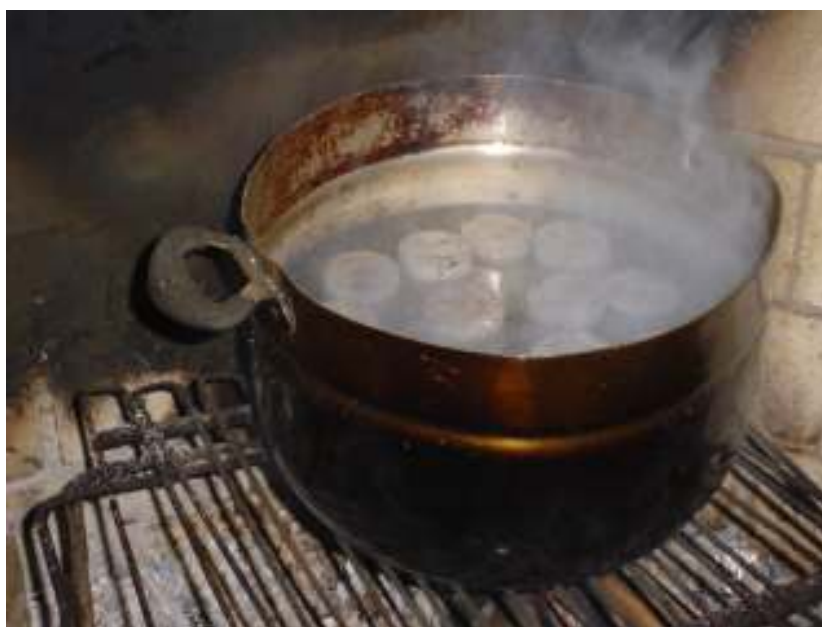
Figura 28: corpos-de-prova de argamassa submetidos à fervura durante 5h
