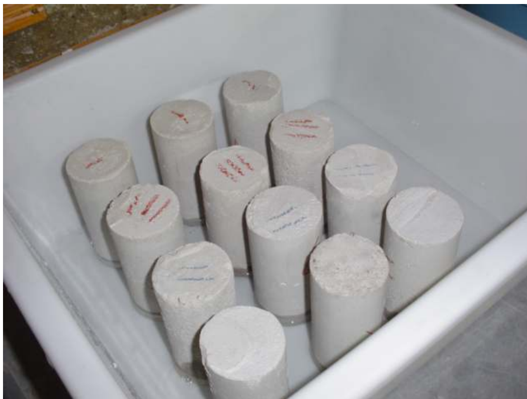
Figura 25: recipiente com nível d'água de 5 \pm 1 mm para o ensaio de absorção por capilaridade
