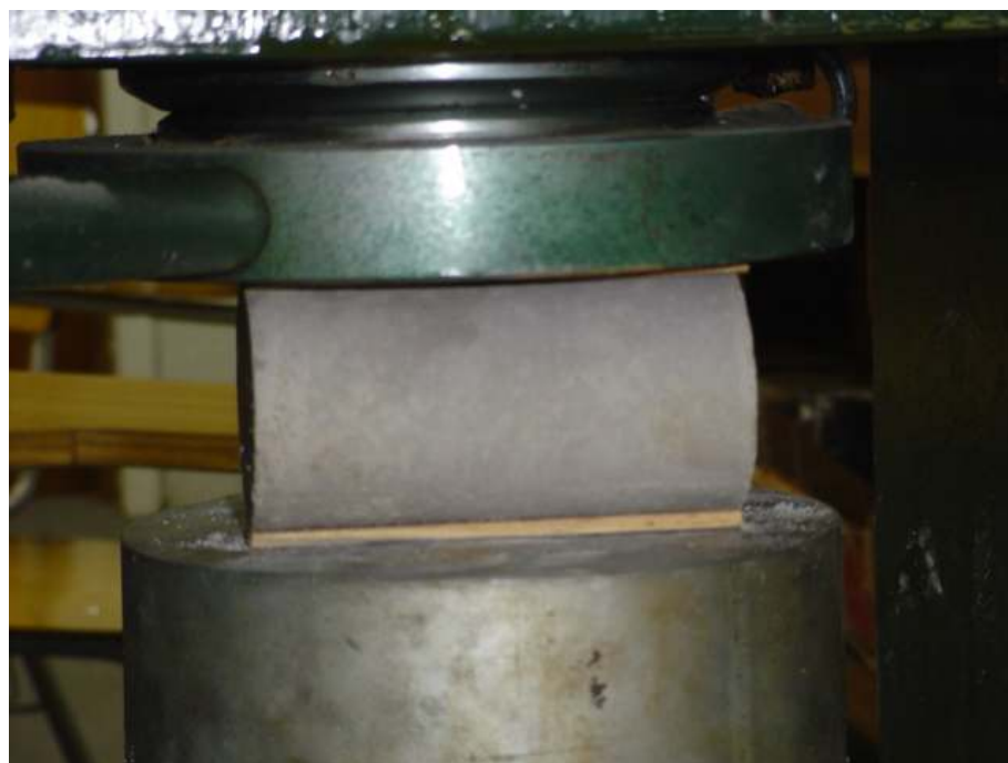
Figura 18: detalhe do ensaio à tração por compressão diametral de corpos-de-prova de argamassa
