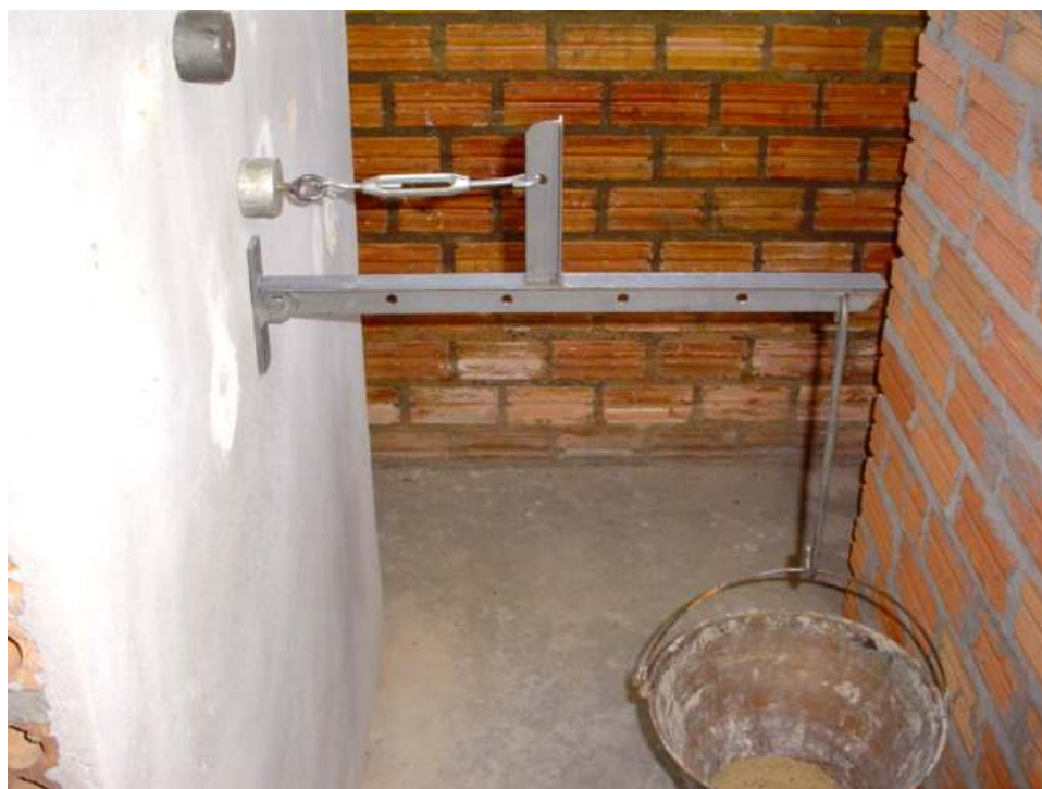
Figura 23: execução do ensaio de resistência à tração direta por arrancamento
