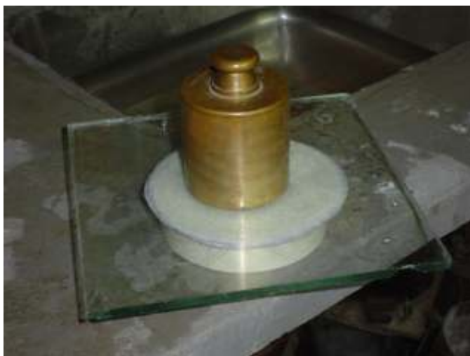
Figura 10: conjunto molde, papéis-filtro e peso para ensaio de retenção de água para argamassa no estado fresco
