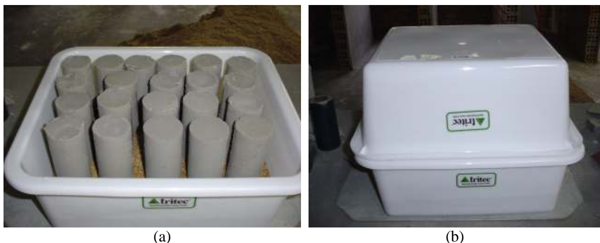
(a) (b) Figura 14: corpos-de-prova em ambiente de laboratório (a) armazenados em caixa plástica; (b) vedados para manter a umidade
