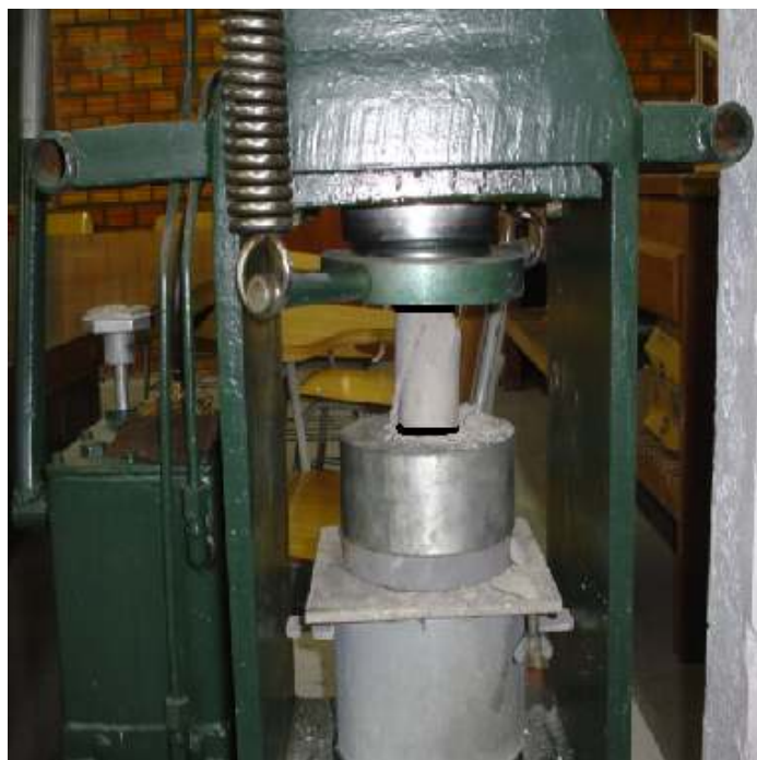
Figura 16: ruptura dos corpos-de-prova de argamassa de 5 x 10 cm submetidos à compressão axial
