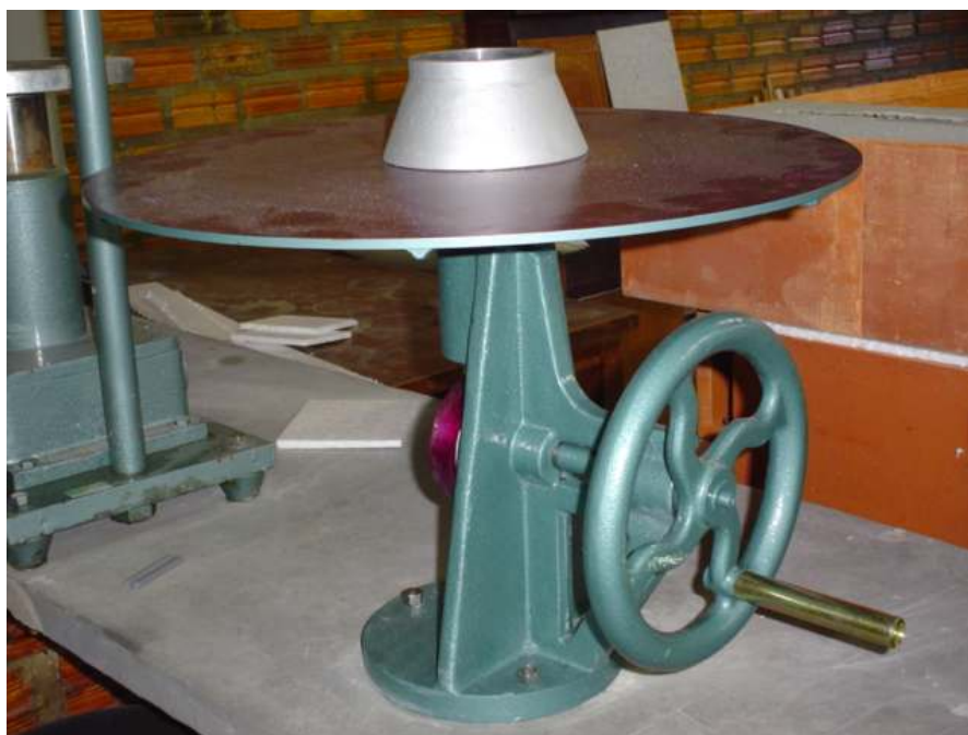
Figura 9: mesa de consistência ( flow table ) com o molde rígido tronco de cone
