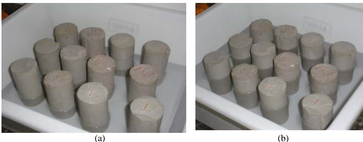
(a) (b) Figura 26: imersão dos corpos-de-prova (a) 1/3 da altura do corpo-de-prova; (b) 2/3 da altura do corpo-de-prova
