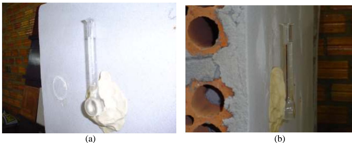
Figura 30: visualização do ensaio de absorção de água pelo método cachimbo (a) fixação do cachimbo de vidro sobre a superfície; (b) vista lateral da fixação
