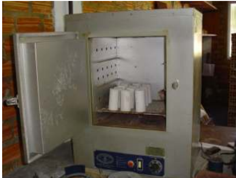
Figura 24: corpos-de-prova na estufa até obtenção da constância de massa para realização do ensaio de absorção por capilaridade
