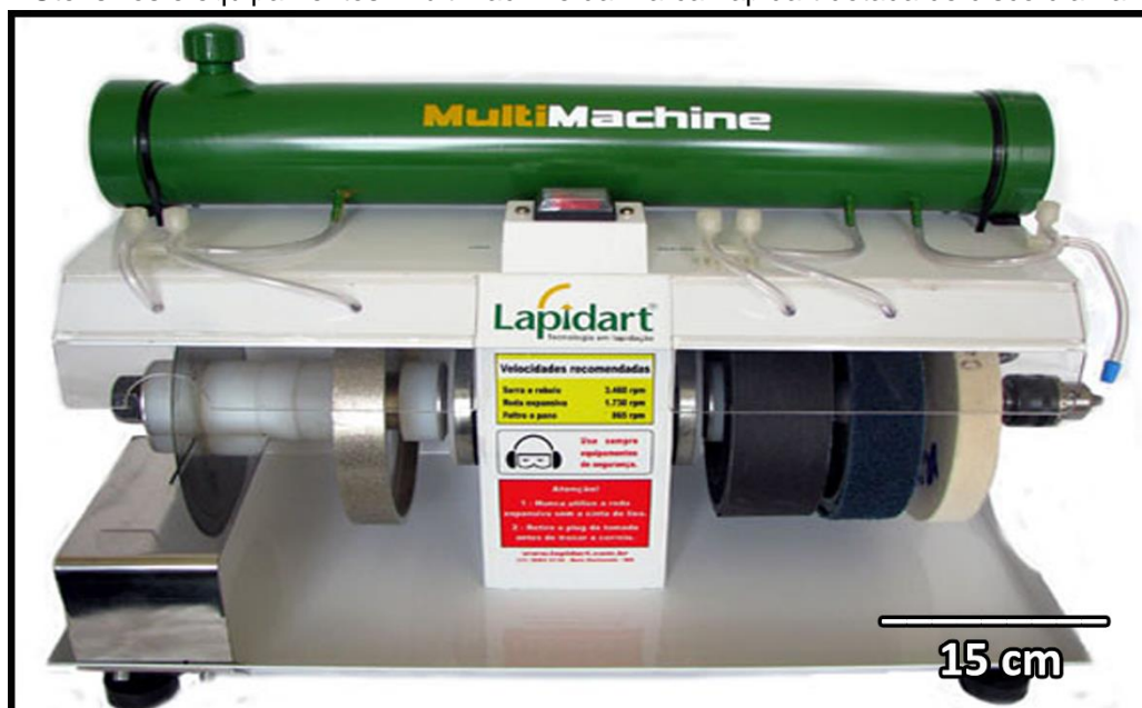
Figura 9 – Utensílios e equipamentos: multimachine da marca Lapidart dotada de disco diamantado
