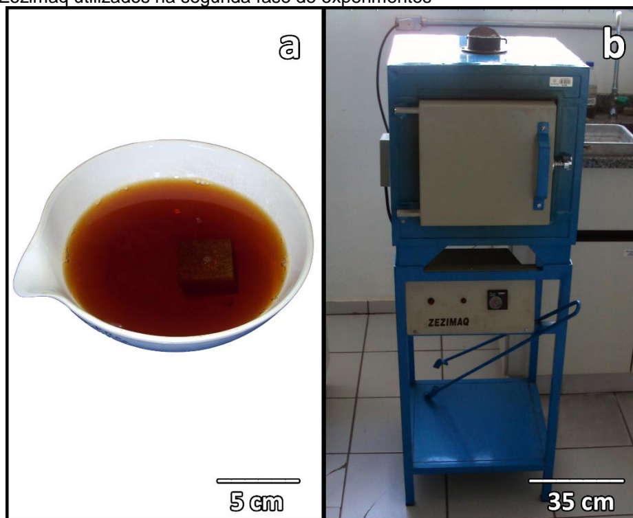
Figura 8 – Utensílios e equipamentos: (a) cadinho de porcelana com amostra imersa em efluente e (b) forno marca Zezimaq utilizados na segunda fase de experimentos
