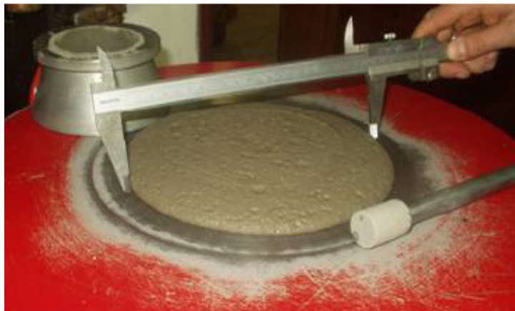
Figura 13: Medida de consistência da argamassa. Fonte: Autor
