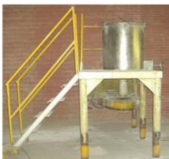
Figura 09: Misturador de Mistura seca. Fonte: Autor.
